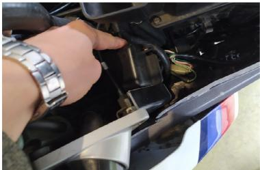
3) Sortir les fils correspondant au boitier de valves (bloc prise 4 broches, et prise 1 broche cylindrique) :
